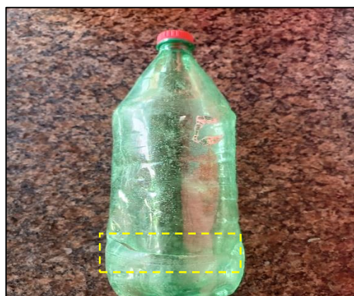
Figura 14: Garrafa PET com corte horizontal na parte inferior. Fonte: Autor (2023).
