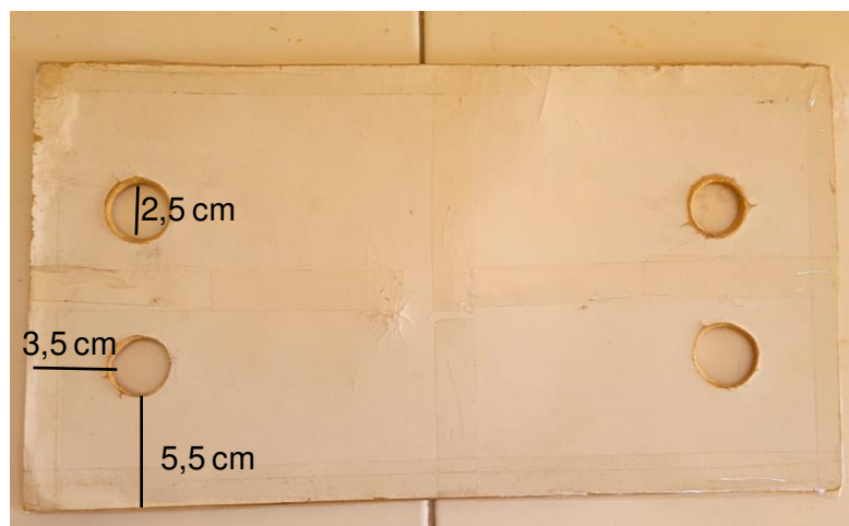
Figura 11 - Plataforma com os 4 furos
